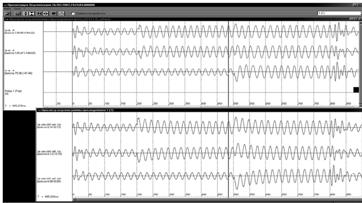
Рис. 13. Осциллограмма, полученная в разработанной системе моделирования (внизу) и осциллограмма, записанная микропроцессорным терминалом (вверху)
