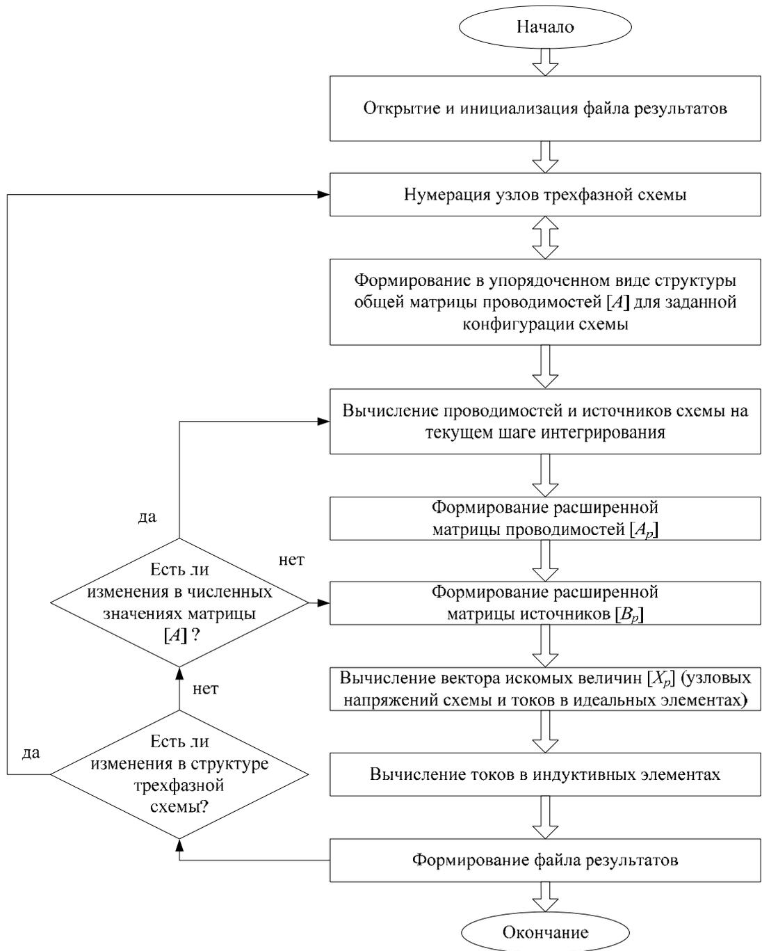
Рис. 5. Блок-схема алгоритма выполнения вычислительного эксперимента
