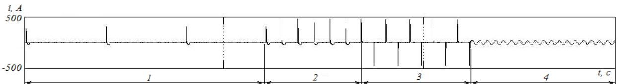
Рисунок 4.21 – Осциллография тока сложного ОЗЗ, где участок 1 – ДПрОЗЗ с  $\Delta t = 200$  мс; 2 – ДПОЗЗ по теории J.F. Peters, J. Slepian с  $\Delta t = 40$  мс; 3 – ДПОЗЗ по теории W. Petersen с  $\Delta t = 30$  мс, 4 – УОЗЗ
