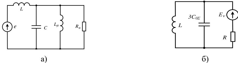
Рисунок 2.14 – Расчетные схемы замещения компенсированных кабельных сетей 6–10 кВ для оценки минимального уровня ВГ в токе ОЗЗ: а – по [138]; б – по [139]
